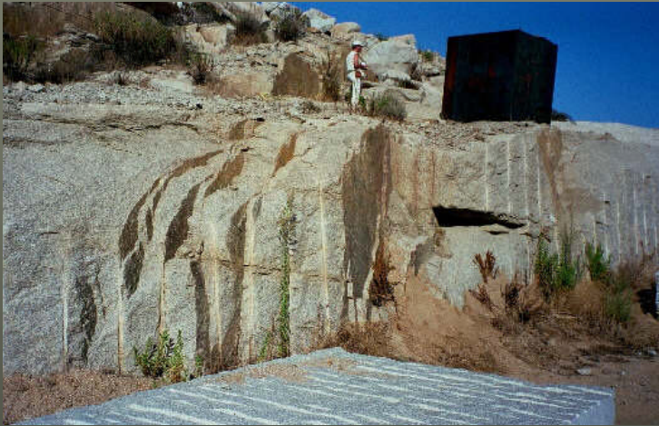
Faisceau de fractures parallèles visibles en 3D dans une carrière de granite
