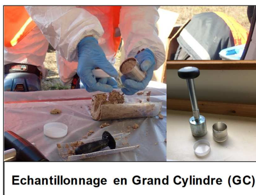
Figure 8 – Méthodes d'échantillonnage mises en œuvre lors de l'essai d'inter-comparaison du BRGM (2018)
