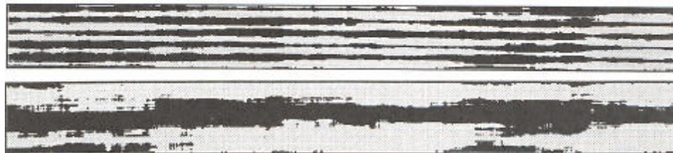
Figure 15. Coupes obtenues par seuillage d'une même réalisation gaussienne, pour deux courbes sinusoïdales de proportion verticale, de périodes différentes. La période représentée en haut  $1/5^{\text{ème}}$  de la hauteur de la coupe, et en bas, elle lui est égale.
