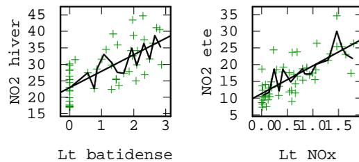
**Figure 11. Mulhouse, campagnes 2001 pour le NO<sub>2</sub>. Nuage de corrélation entre les mesures hivernales et le logarithme translaté du bâti dense, et entre les mesures estivales et le logarithme translaté du cadastre des émissions en oxydes d'azote. Les concentrations sont en µg/m<sup>3</sup>, la variable auxiliaire est rendue adimensionnelle.**
