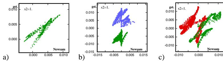
**Figure 18. Nuage de corrélation des perturbations de la charge entre le calcul par différences finies (code Newsam, CIG - Ecole des Mines de Paris) et la simulation géostatistique, en ordonnée. a) zone centrale, 20mx20m. b) limites à charge imposée, 10mx100m. c) limites imperméables, 100mx10m. La variance logarithmique de la transmissivité est égale à 1.**
