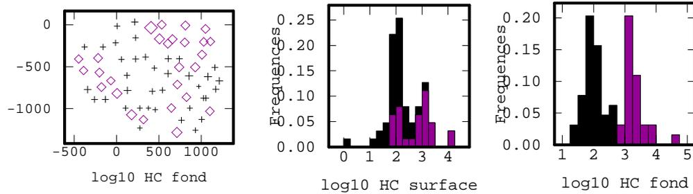
**Figure 3. Ancien site pétrochimique, échantillonnage systématique à maille large. Carte d'implantation des prélèvements (à gauche) et histogrammes du logarithme décimal des teneurs en hydrocarbures totaux, en surface (au milieu) et en profondeur (à droite). Les deux modes des teneurs en « profondeurs » sont visualisés sur l'histogramme de « surface » ainsi que sur la carte d'implantation (+ pour le mode faible, ? pour le mode fort).**
