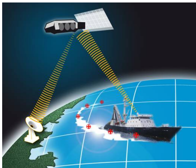
Fig. 36 : Schéma de transmission de la donnée de position GPS (points rouges) par le système VMS.
