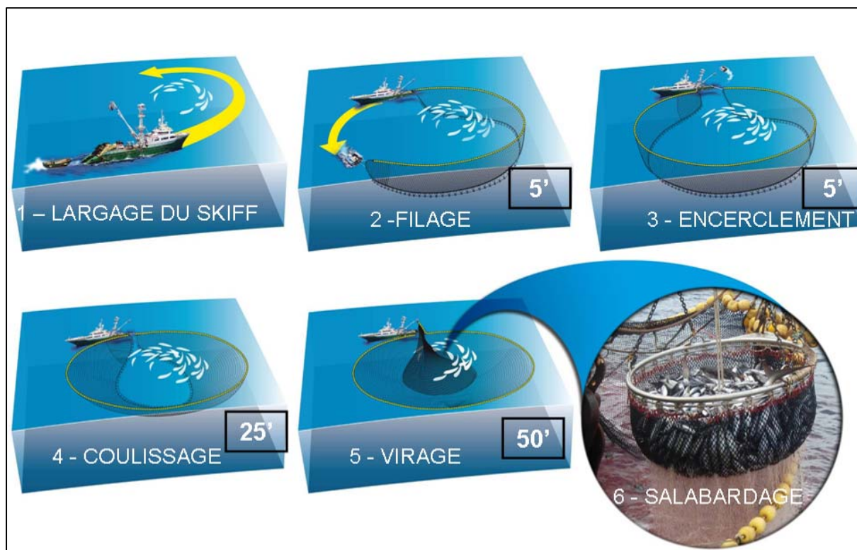
Fig. 21 : Déroulement d'un coup de senne avec durée de chaque étape en minutes. Le navire est immobile pendant au moins 1h30. Le salabardage dure un temps variable supplémentaire de l'ordre de 1h pour 100 tonnes pêchées.
